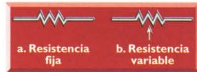
Figura 6.2. Símbolos de las resistencias fijas y variables
